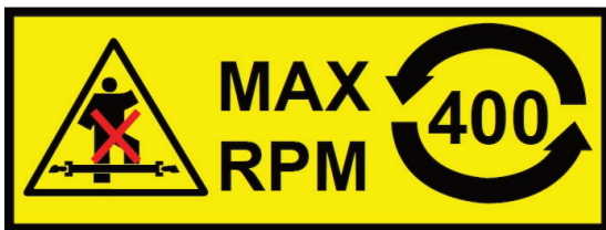
Uważać na obracający się wał! Maksymalna dozwolona prędkość obrotowa i kierunek obrotów wału odbioru mocy.
