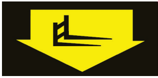
Miejsce podnoszenia za pomocą wózka widłowego
